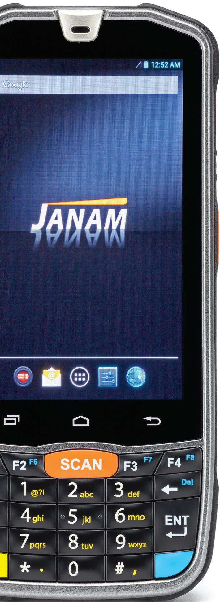
Abgedichtet nach IP67 und unempfindlich gegen Stürze aus 1,5 m Höhe auf Beton – der robuste XM75 übersteht extreme Temperaturen und Stöße im täglichen Gebrauch. Die 2-Jahres-Standardgarantie vermittelt Kunden nicht nur die Sorgenfreiheit, sondern auch das Maß an Service, das sie brauchen, und zwar ohne Zusatzkosten – mit optionalen, umfassenden Servicepaketen für Kunden, die ihre Mobile Computing-Investition weiter ausbauen möchten.
